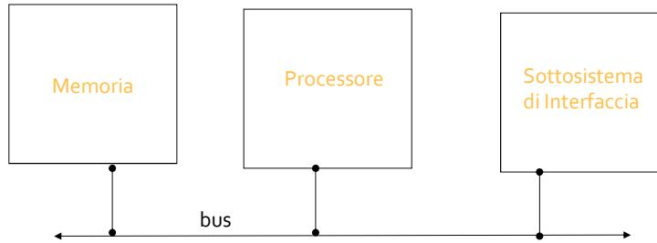
La comunicazione fra i tre sottosistemi viene effettuata attraverso un dispositivo fisico detto **bus di interconnessione**. Attraverso il bus la CPU
