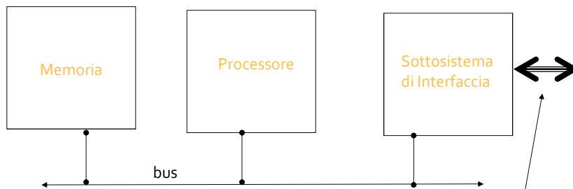
Il sottosistema di interfaccia cura anche la comunicazione fra due calcolatori diversi (es. via telefono\modem, via ethernet\con opportune schede di connessione)
